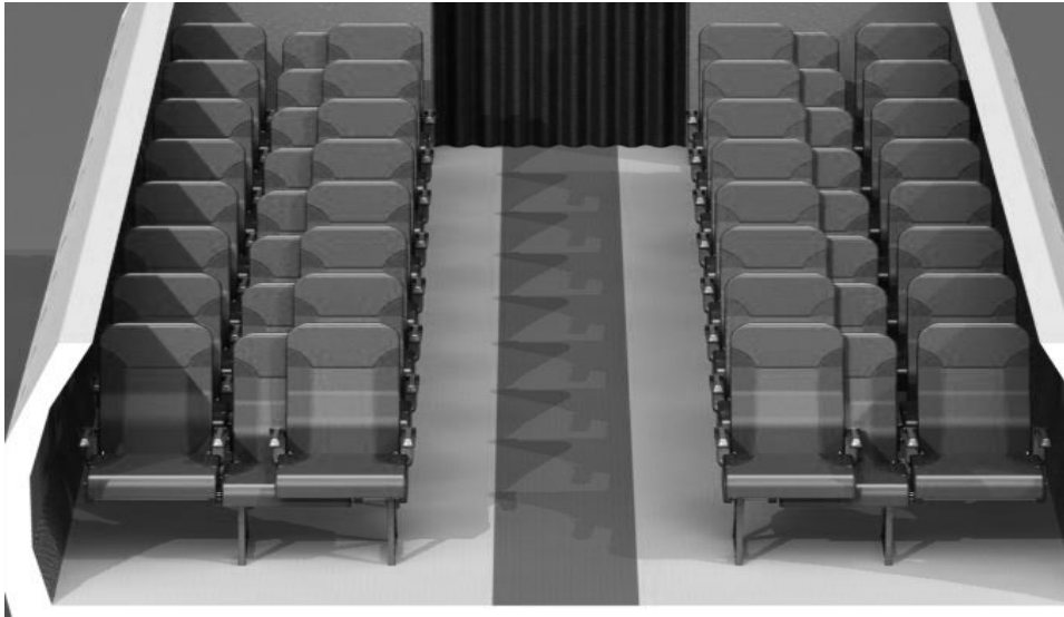
Slika 3.5. Prikaz sjedala Molon Labe Design kada se bočno sjedalo prebaci preko središnjeg sjedala (www.molonlabedesigns.com)
