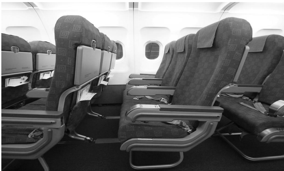
Slika 4.1. Stara sjedala RECARO 3410 series 773 u putničkoj kabini CA (Izvor: Croatia Airlines)
