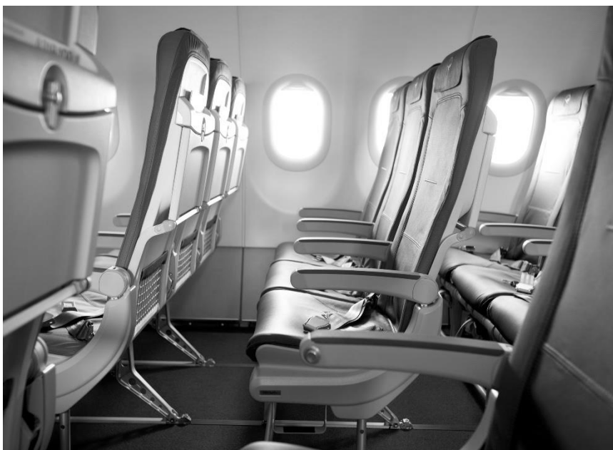
Slika 4.2. Nova putnička sjedala RECARO BL3520 u putničkoj kabini CA ( www.flightglobal.com )
