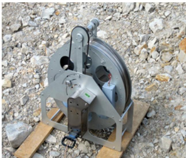
Slika 5. Vitlo s mineralno izoliranim kablom
