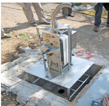
Slika 4. Traktorska jedinica postavljena na aluminijsku ploču
